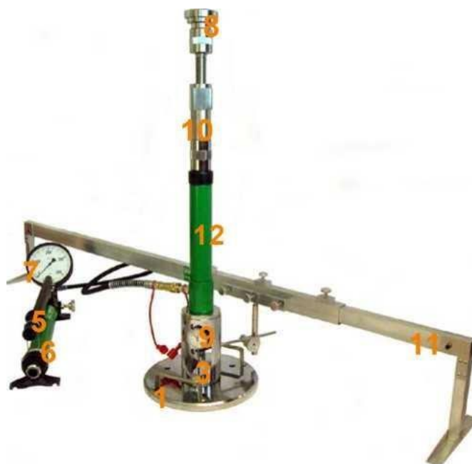
Rys. 1.2 Aparatura VSS z jednopunktowym pomiarem przemieszczenia płyty
